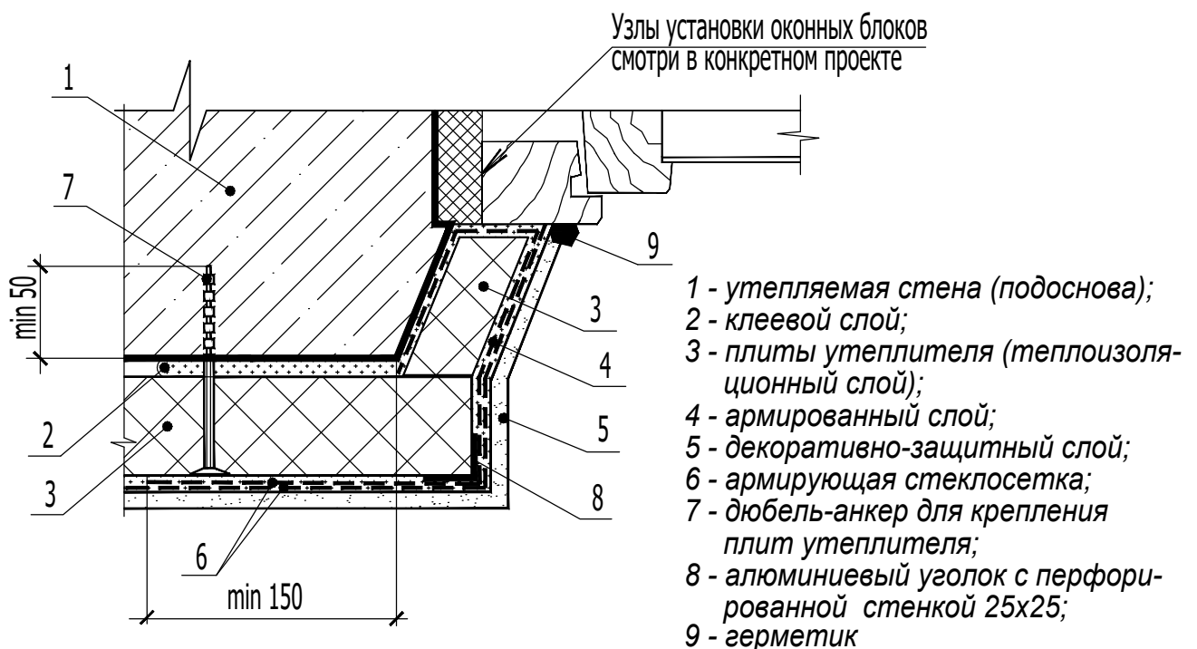
Рисунок А.41 - Узел отделки утепляемого верхнего откоса окна панельного здания
