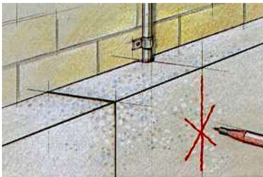
Рисунок 19 – Устройство разметки в местах прокладки инженерных сетей
